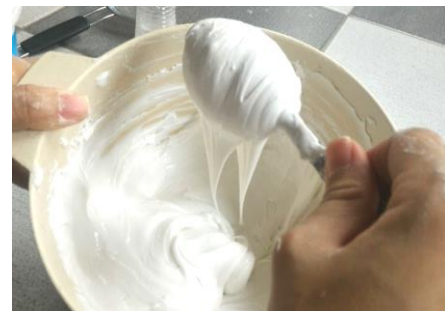
Gambar 3 Campuran cat alternatif clay tepung yang telah jadi dan siap untuk dicampurkan biang warna sesuai dengan warna yang dibutuhkan.
