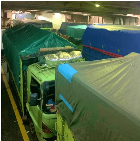
Gambar 2 Kendaraan Yang Terletak Di Buritan Tidak Dilashing
