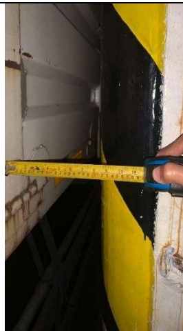
Hasil pengukuran menunjukkan bahwa jarak kendaraan terhadap dinding kapal yaitu 21 cm.
