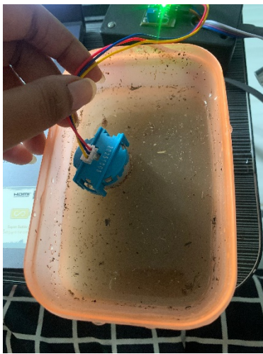
Gambar 4. (a) Monitoring kekeruhan di air agak keruh, (b) Tampilan pada aplikasi blynk
