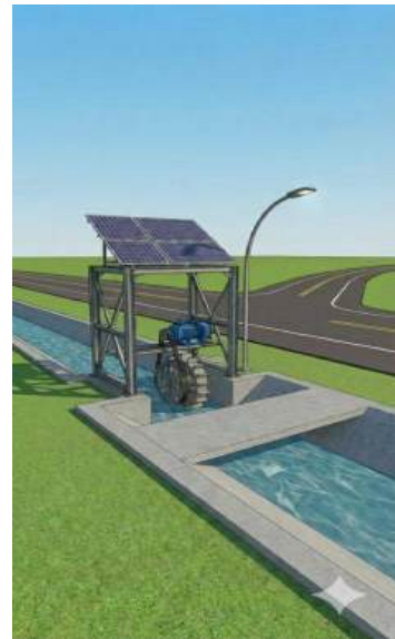
Gambar 3. Rancangan Tiga Dimensi Purwarupa Sistem Hibrida
