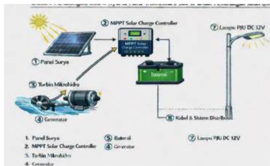
Gambar 2. Diagram Blok Sistem Hibrida PLTS–Mikrohidro 500 W
