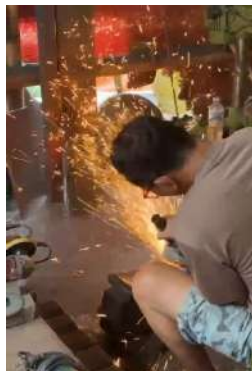
Gambar 2. Proses Pembuatan Gamelan Berbahan Dasar Besi
