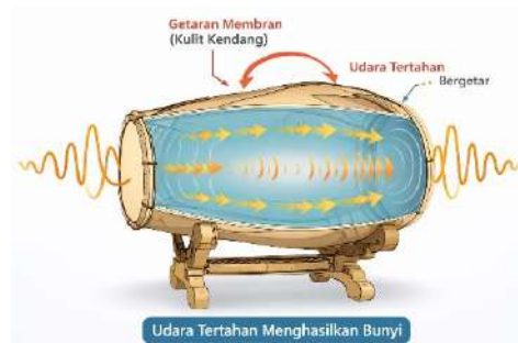
Gambar 5. Ilustrasi Mekanisme Resonansi Udara di Dalam Kendang
