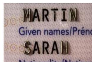
Gambar 4.13. *Tactile Laser Engraving* pada Paspor Kanada
