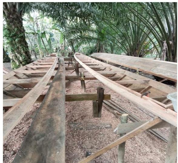
**Gambar 3.** Foto proses pembuatan Perahu *penceran*
