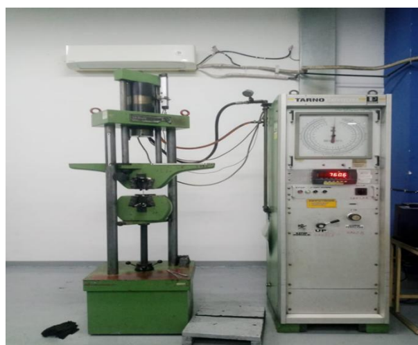
Gambar 6. Mesin uji tarik yang digunakan
