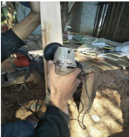
Gambar 10. Proses Penggerindaan mengikuti Bentuk Mal Airfoil
