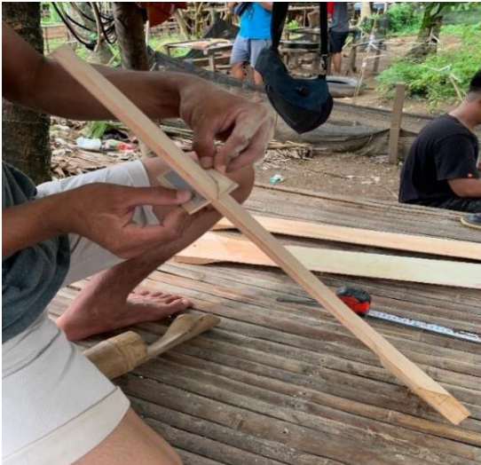
Gambar 12. Proses Pencocokan Mal Airfoil dengan Bilah yang Sudah dibentuk
