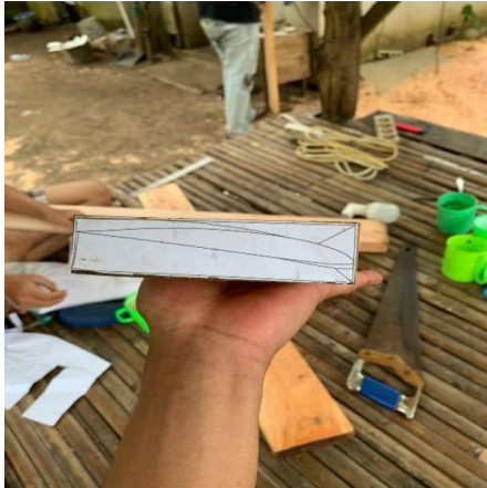
Gambar 9 Penempelan Mal Airfoil pada ujung Bilah
