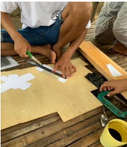
Gambar 7. Proses pembuatan Mal Airfoil pada triplek
